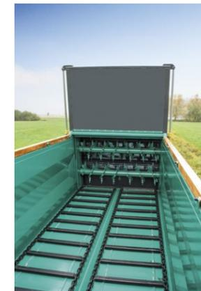
Kratzbodenleisten Hydraulischer Stauschieber
