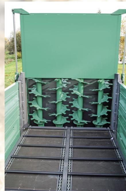
Kratzbodenleisten Hydraulischer Stauschieber
