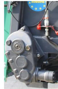
Getriebe + Danfoss-Ölmotor
