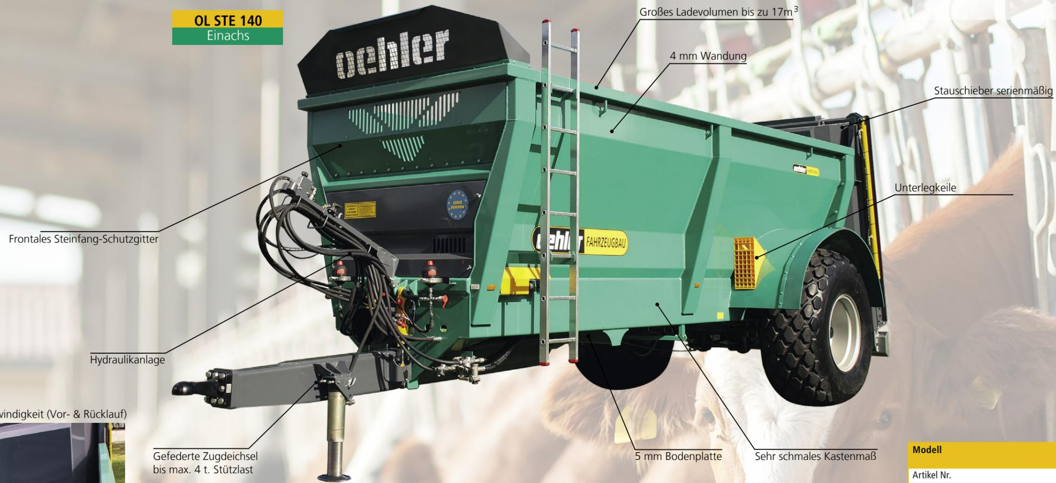
Stufenlose Kratzbodengeschwindigkeit (Vor- & Rücklauf)
