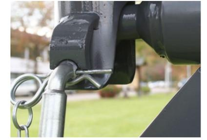
Kipplager mit Überkreuzstecksicherung
