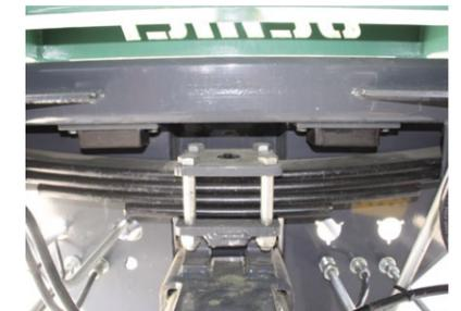
Gefederte Zugdeichsel bis max. 4t Stützlast
