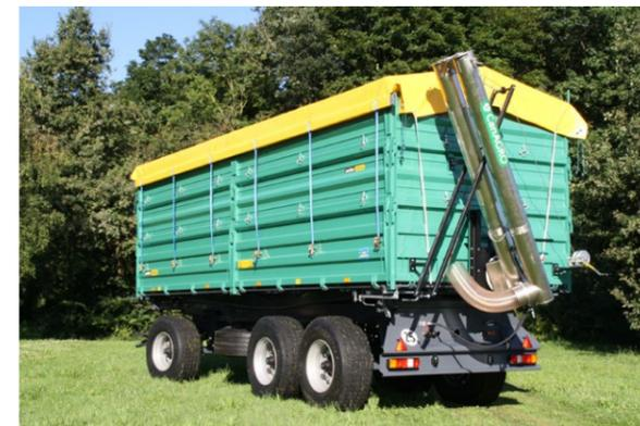
OL DDK 240 mit zusammengeklappter Kornschnecke
