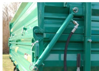
Hydraulisch verschließbare Bordwand
