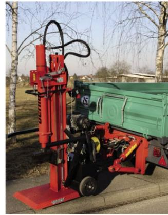
OL EDK 60 S mit Dreipunktbau und Zapfwelldurchtrieb mit Holzspalter OL 190
