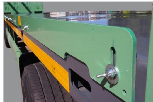
Verstellbare Sicherungsleiste für Großkistentransport
