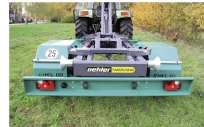
OL EHKL 80 Unterfahrerschutz mit Beleuchtungsanlage
