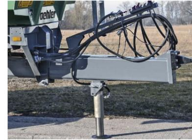
Hydraulischer Stützfuß, doppelwirkend
