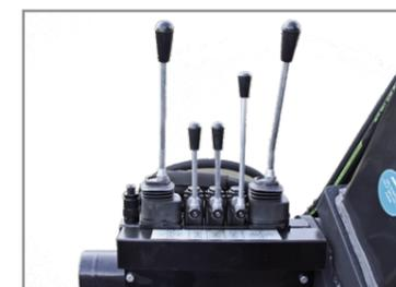
Kreuzhebelsteuerung 7-fach mechanisch
