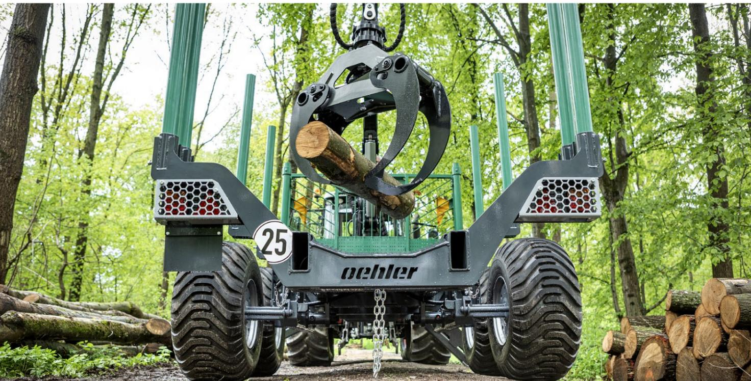
Einrohrrahmen mit verstellbaren Rungen
