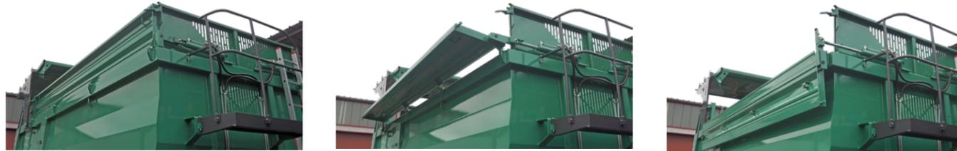
Hydraulisch abklappbarer Aufsatz
