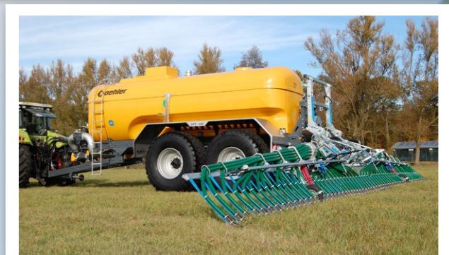
BOMECH Quality by Experience PPT 185 GFK 18.500 Liter Tandem-Pumptankwagen mit 15 mtr. Schleppschuh
