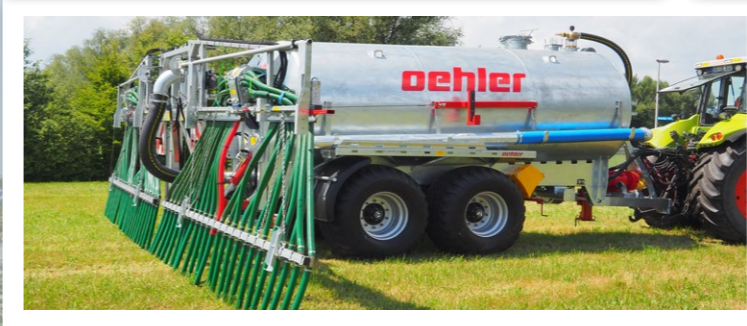
VKT 120 12.000 Liter Tandem-Vakuumtankwagen mit Schleppschlauchverteilung
