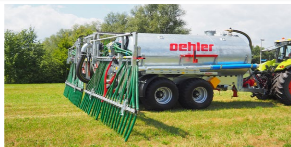
VKT 120 12.000 Liter Tandem-Vakuumtankwagen mit Schleppschlauchverteilung
