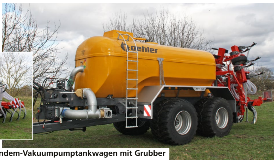
VKT 140 14.000 Liter Tandem-Vakuumtankwagen mit 15 mtr. Schleppschuhverteilung
