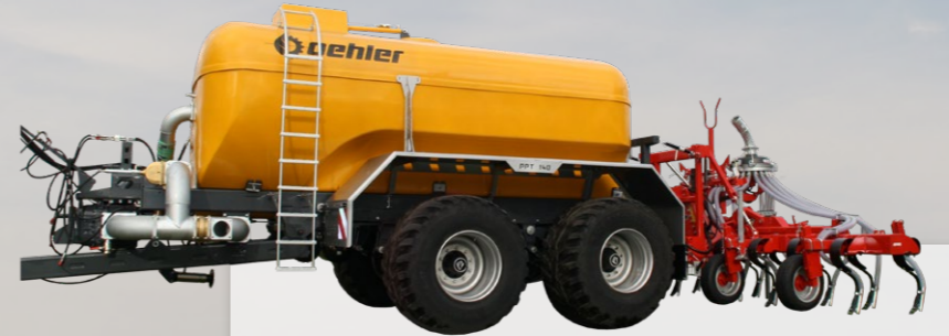
evers PPT 165 GFK 16.500 Liter Tandem-Pumptankwagen mit Grubber
