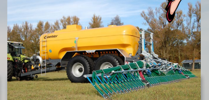
BOMECH PPT 185 GFK 18.500 Liter Tandem-Pumptankwagen mit 15 mtr. Schleppschuh
