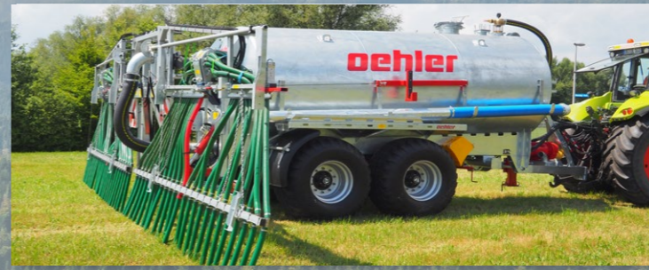
VOGELSANG VKT 120 12.000 Liter Tandem-Vakuumtankwagen mit Schleppschlauchverteilung
