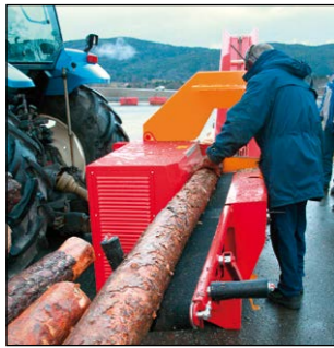
Verladeband mit Reinigungseinrichtung schwenkbar
