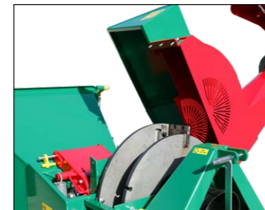
Einfache Zugänglichkeit der Maschine bei Wartung
