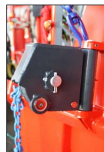
Magnet zur Fixierung der unteren Seilrolle
