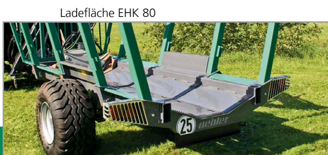
Einrohrrahmen mit verstellbaren Rungen
