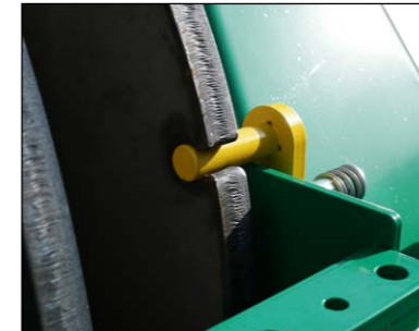
Sicherungsbolzen für Schneidwerk bei Wartung
