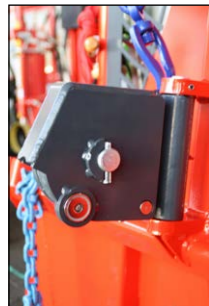
Magnet zur Fixierung der unteren Seilrolle
