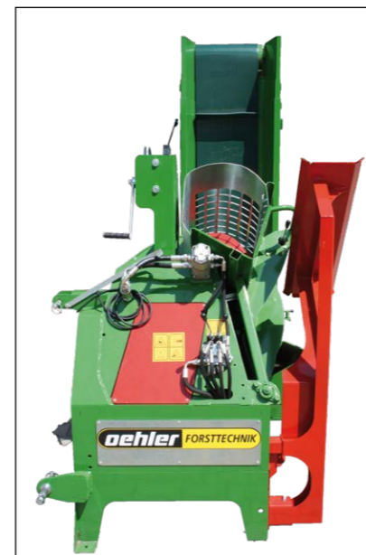
Hydraulische Pumpe und Bedienung
