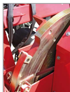
enorm robuste Häcksel- scheibe mit Holzaustrif
