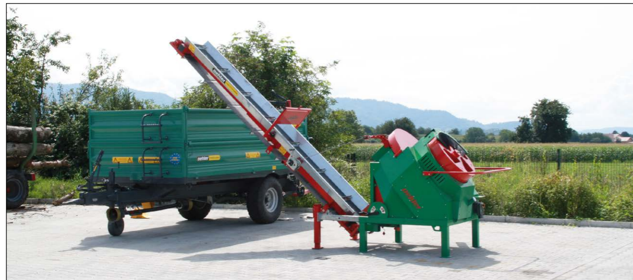
Höhenverstellbares Förderband, 2 fach teleskopierbar
