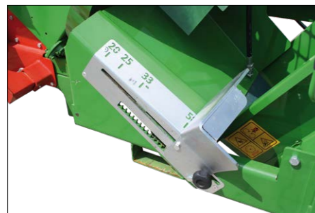
Variable Schnittlängeneinstellung 20,25,33,50 cm
