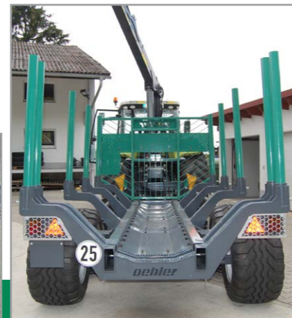
Kompakter stabiler Doppelrohrrahmen
