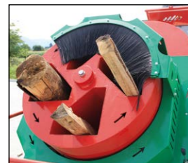
4 Kanäle der Sägetrommel
