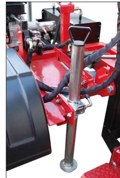
Zusätzlicher Stützfuß für mehr Standsicherheit
