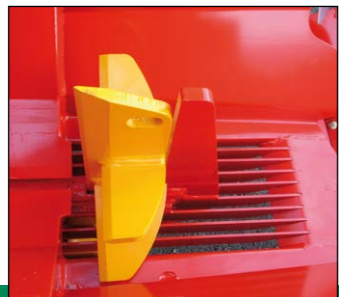
6-fach Spaltkreuz mit Reinigungseinrichtung
