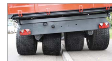
OL EDK 60 SG Höhenausgleich durch Pendelachse
