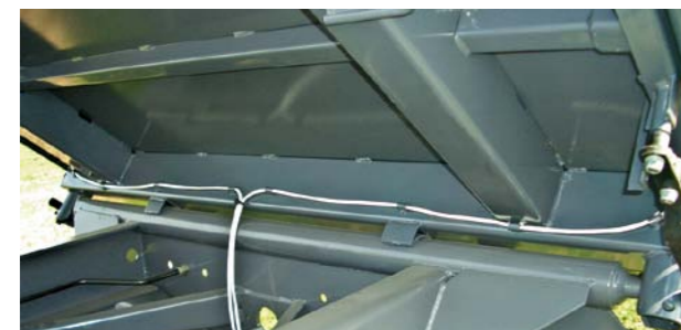
Zusätzl. Abtütz. der hinteren Kippwelle ab OL TKD 80
