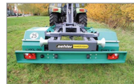
OL EHKL 80 Unterfahrschutz mit Beleuchtungsanlage
