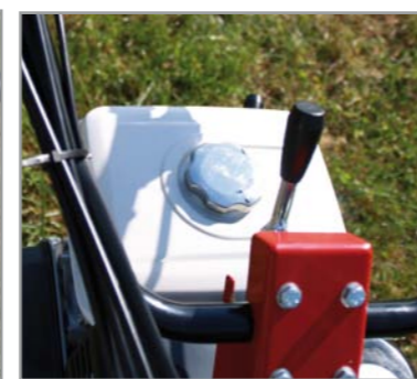
Führungsholm seiten- und höhen- verstellbar
