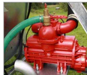
Hochleistungskompressor mit Ölauffangschalter
