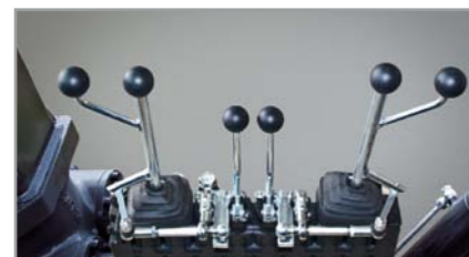
6-fach Steuerung mechanisch
