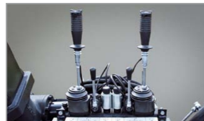
Kreuzhebel, 6-fach Steuerung mechanisch, 2-fach-elektrisch
