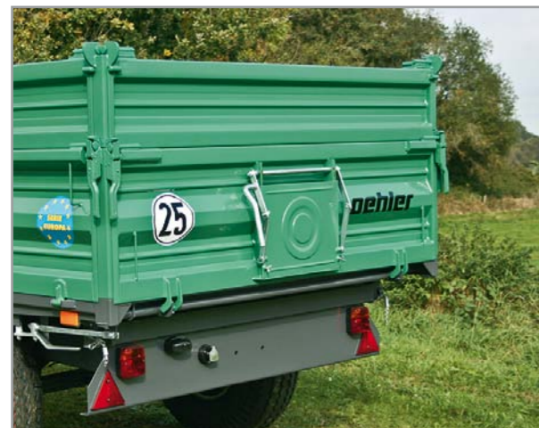
OL EDK 50 Zentralverriegelung hinten – Kornschieber und Unterfahrschutz
