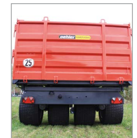
OL EDK 60 SG 1000mm durchgehende Bordwand
