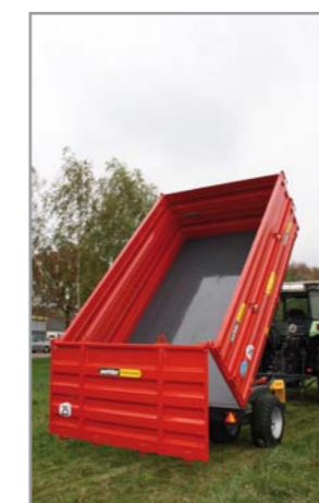
OL EDK 60 SG 1000mm pendelbare Rückwand
