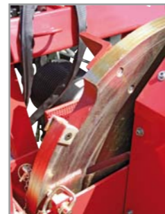
enorm robuste Häcksel- scheibe mit Holzaustritt
