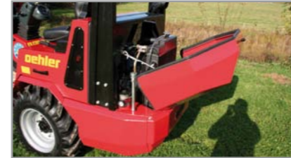
Motorhaube seitlich kippbar
