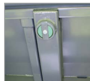
Robuste, eingeschweißte Rungenhalterung
