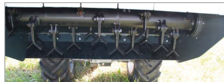
Robustes, langlebiges Schneidwerk mit Y-Messer
