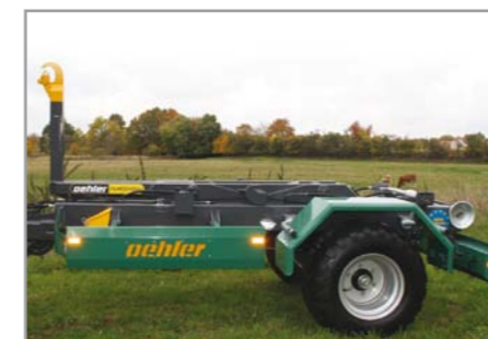
Kotflügel und Seitenanfahrerschutz
