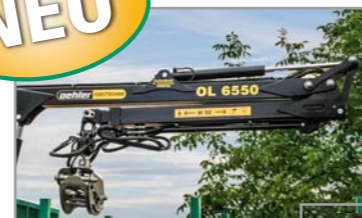
Komplettes Einschwenken des Auslegearms möglich
