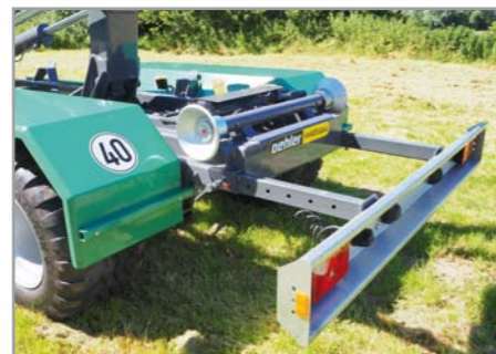
OL THKL 130 ausziehbarer Unterfahrerschutz
