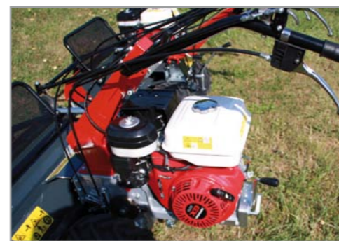
Besonders wartungsfreundlich durch bewährte Honda GX Motoren
