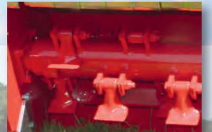
Rotorwelle mit eingebautem Hammer-Schlegel
