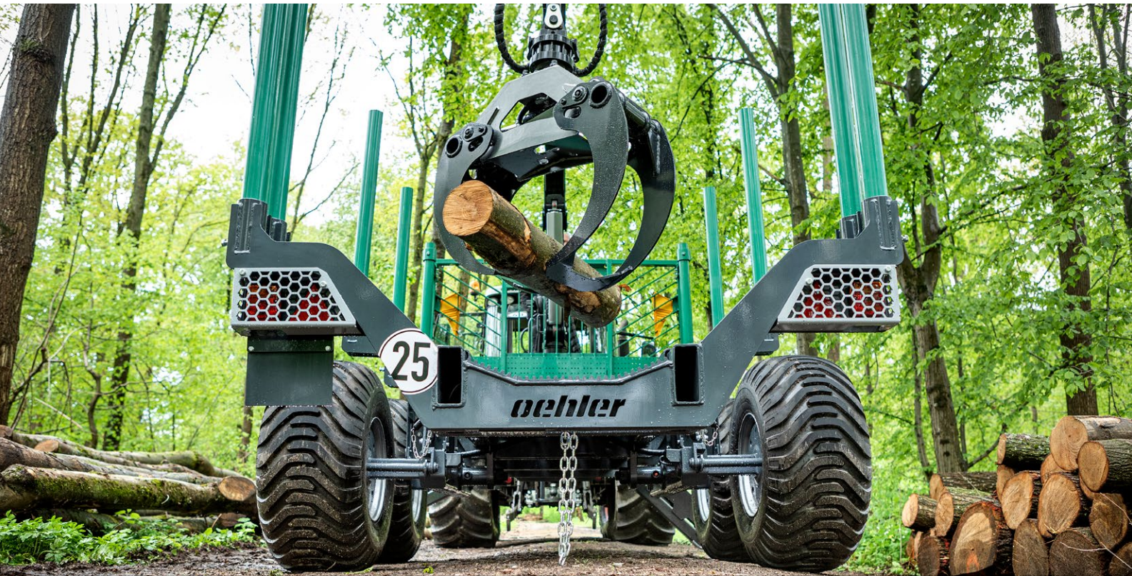
Tandem-Holzrückewagen THK90P und Holzrückekran OL7400SG/P mit Bereifung 400/60-15.5 DELI Forest
