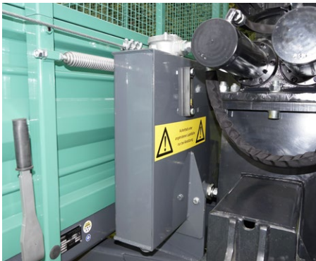
Tank eigene Ölversorgung
