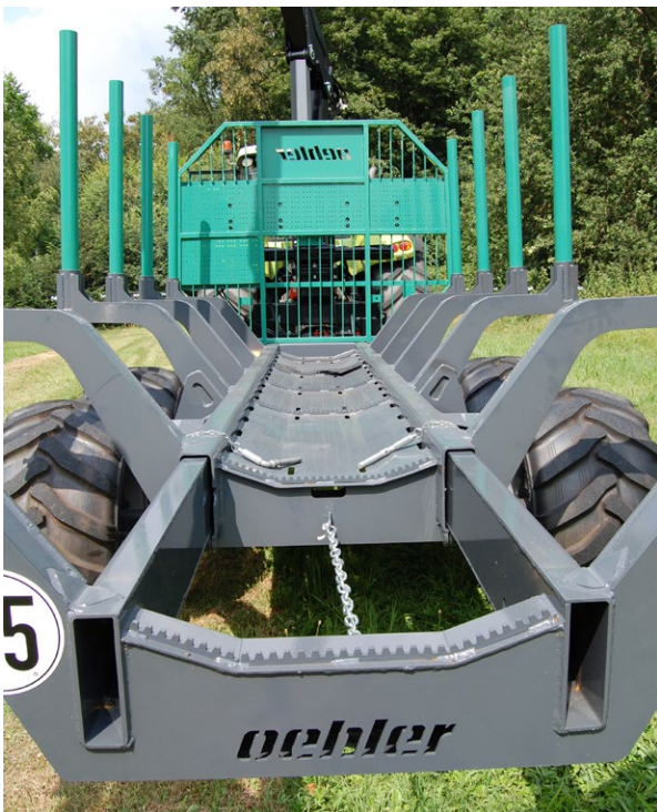
Stabiler und ausziehbarer Doppelrohrrahmen
